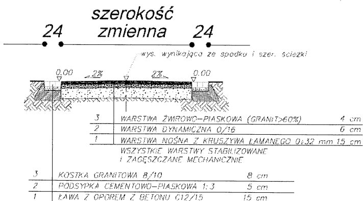
Rys. 2 Przekrój nawierzchni tłuczniowej
