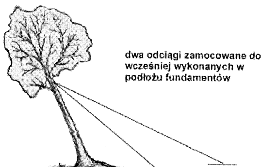
Rys. 2. Schematyczny sposób ustawienia odciagu dwulinowego zakotwionego w gruncie.
